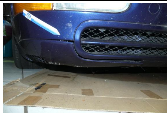
Stoßfängerverkleidung unten rechts gebrochen
