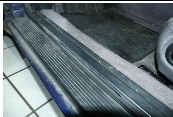
Türabdichtung links gerissen
