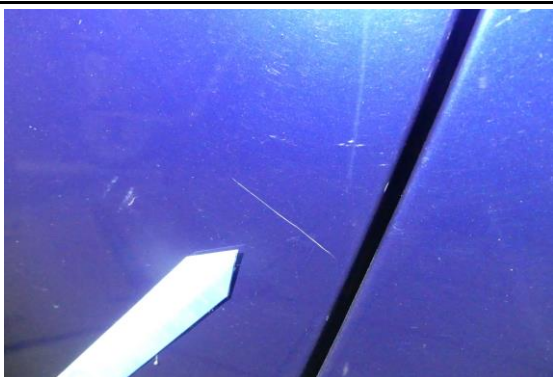
Tür links verkratzt
