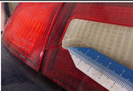
Heckleuchte / Leuchtenband Glas gerissen
