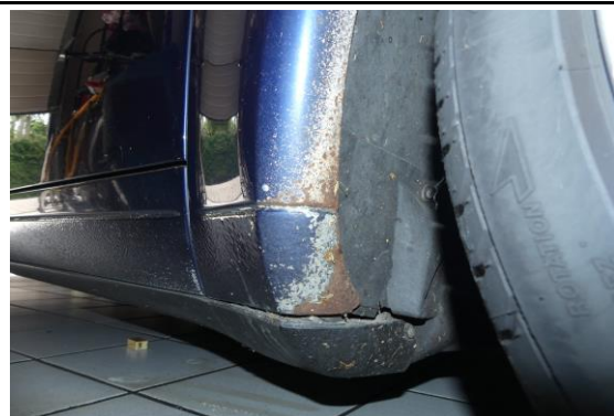
Schweller / Kotflügel rechts Korrosion
