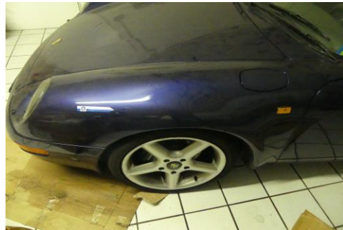
Kotflügel links verkratzt
