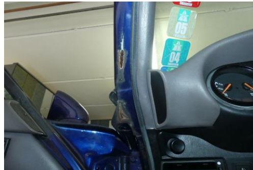
A-Säule links korrodiert
