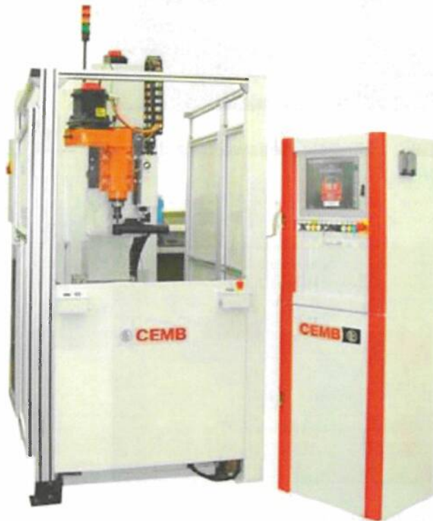
Bild: Ausführung Schutzeinrichtung (hier dargestellt mit integrierter automatisch gesteuerten Bohreinheit)
