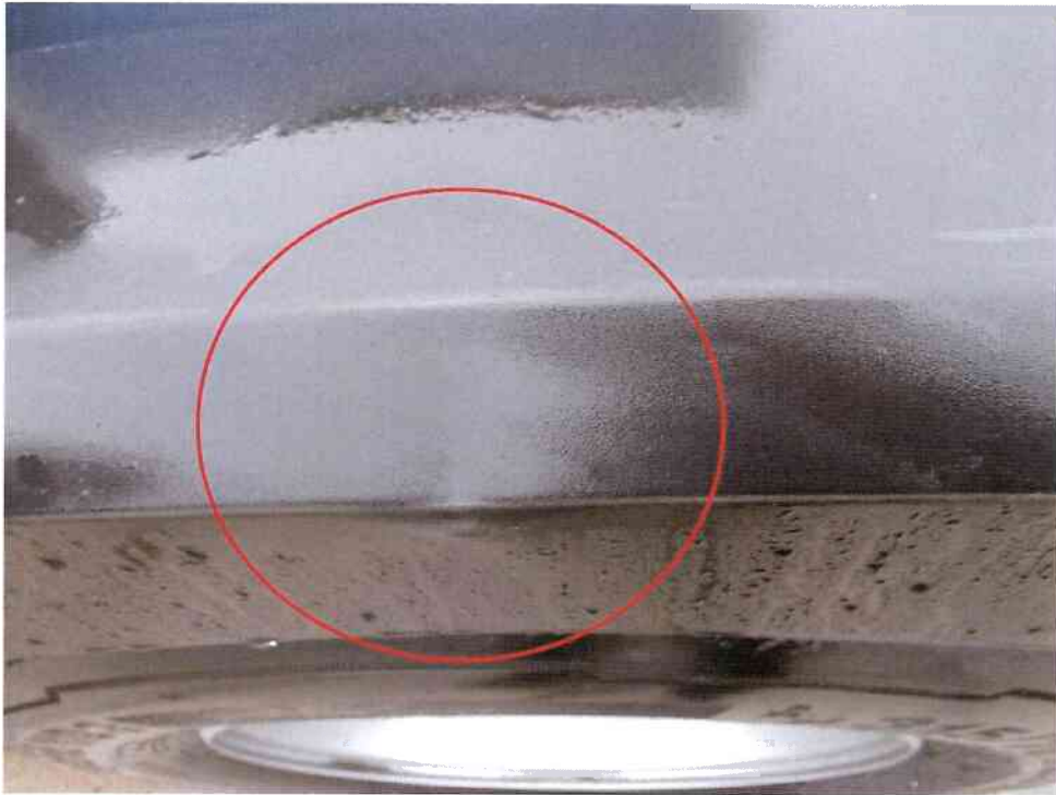
Bild 7 : Kotflügelabdeckung hi.li. gestaucht, Gebrauchsschaden
