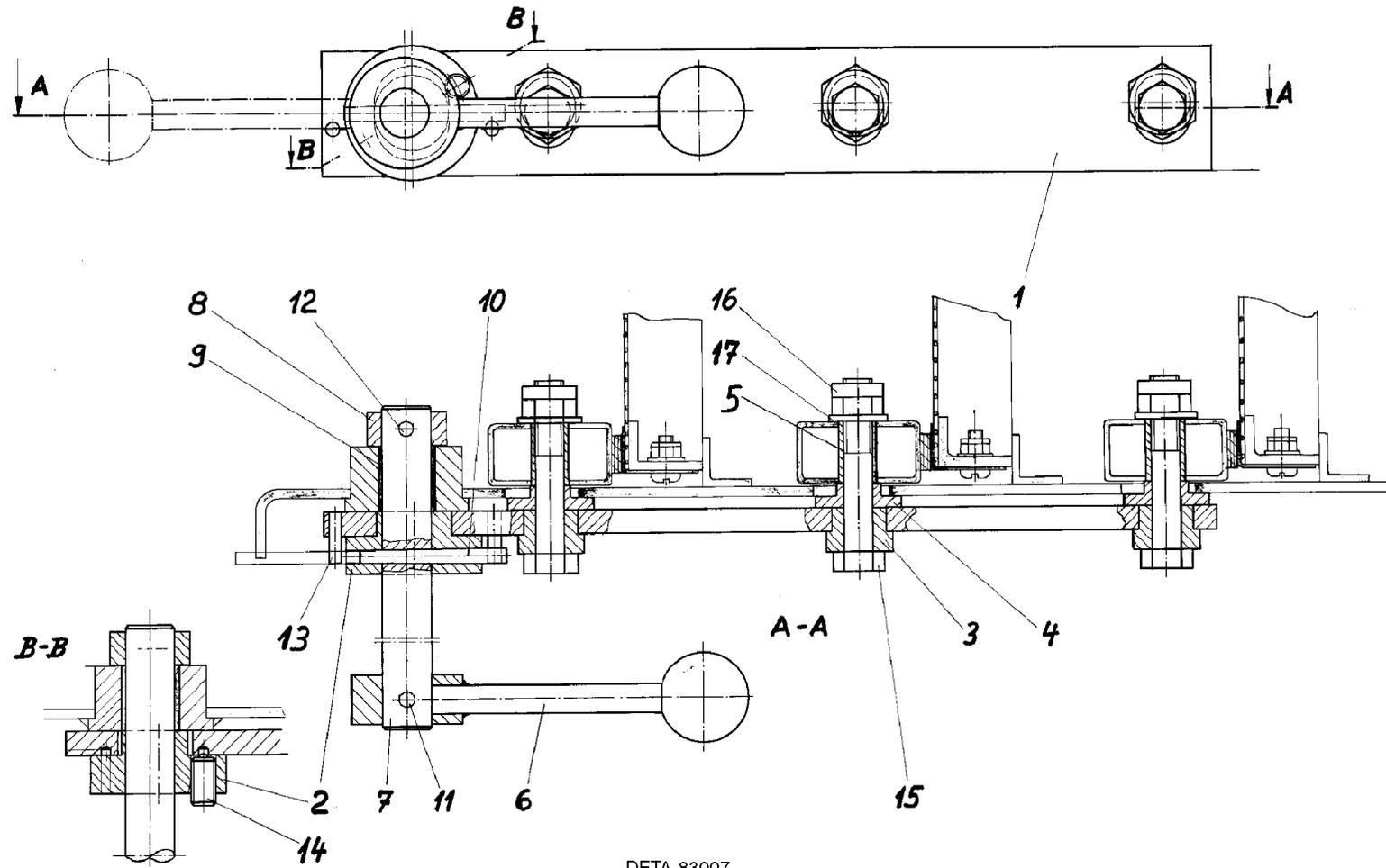
**DFTA-83007-810****Siebklemmung zu Wurfsieb DFTA-23 (bei 2 oder 3 Lagen)**
