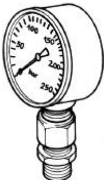
Der mit dem Schleppersteuergerät einstellbare Druck ist an diesem Manometer abzulesen.
