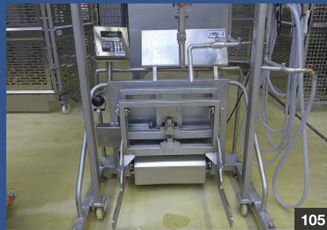
105 “METTLER/WB” Rezepturwaage für Normwagen • formula scale for standard containers
