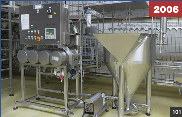
"MONDINI" VSP/L (2006) VA Soßenfüller • s/s sauces filler
