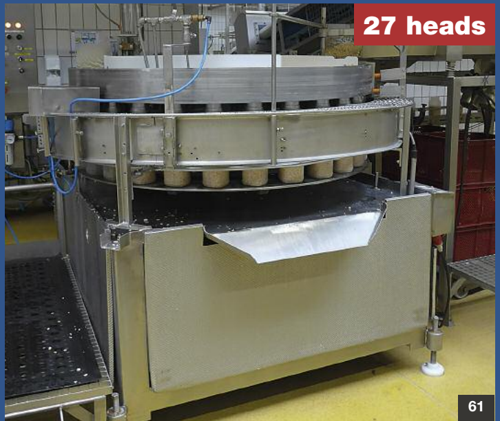
“ENGLER” Taschendosierfüllmaschine • bag dosing filling machine 27 heads, max. 320 cans/min.
