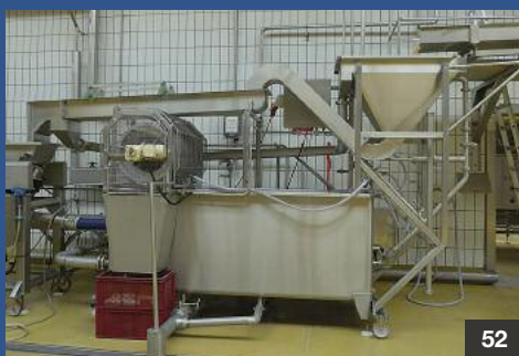
48- 49 “HERBORT” - Blancheur • blancheur drum ø 1100x5000 mm
