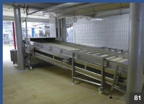
48- 49 “HERBORT” - Blancheur • blancheur drum ø 1100x5000 mm
