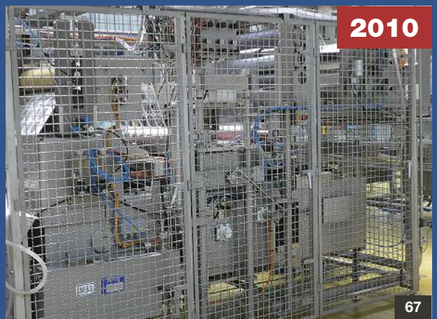
“ENGLER” Taschendosierfüllmaschine • bag dosing filling machine 27 heads, max. 320 cans/min.
